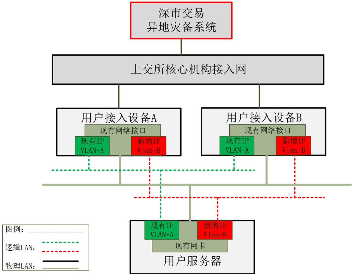
图2 托管用户接入模式——用户内网复用所有线路
