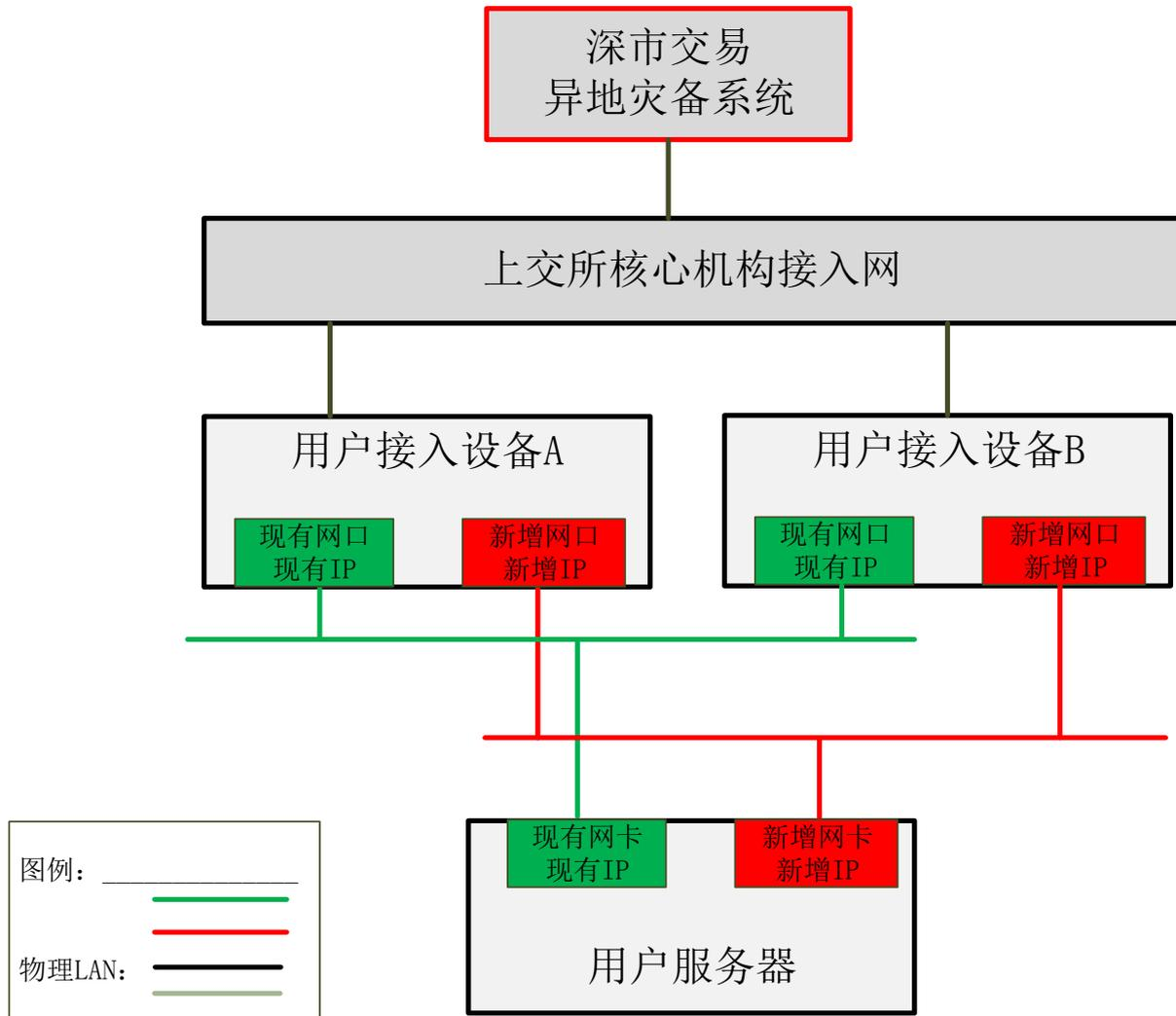
图3 托管用户接入模式——用户内网新增线路
