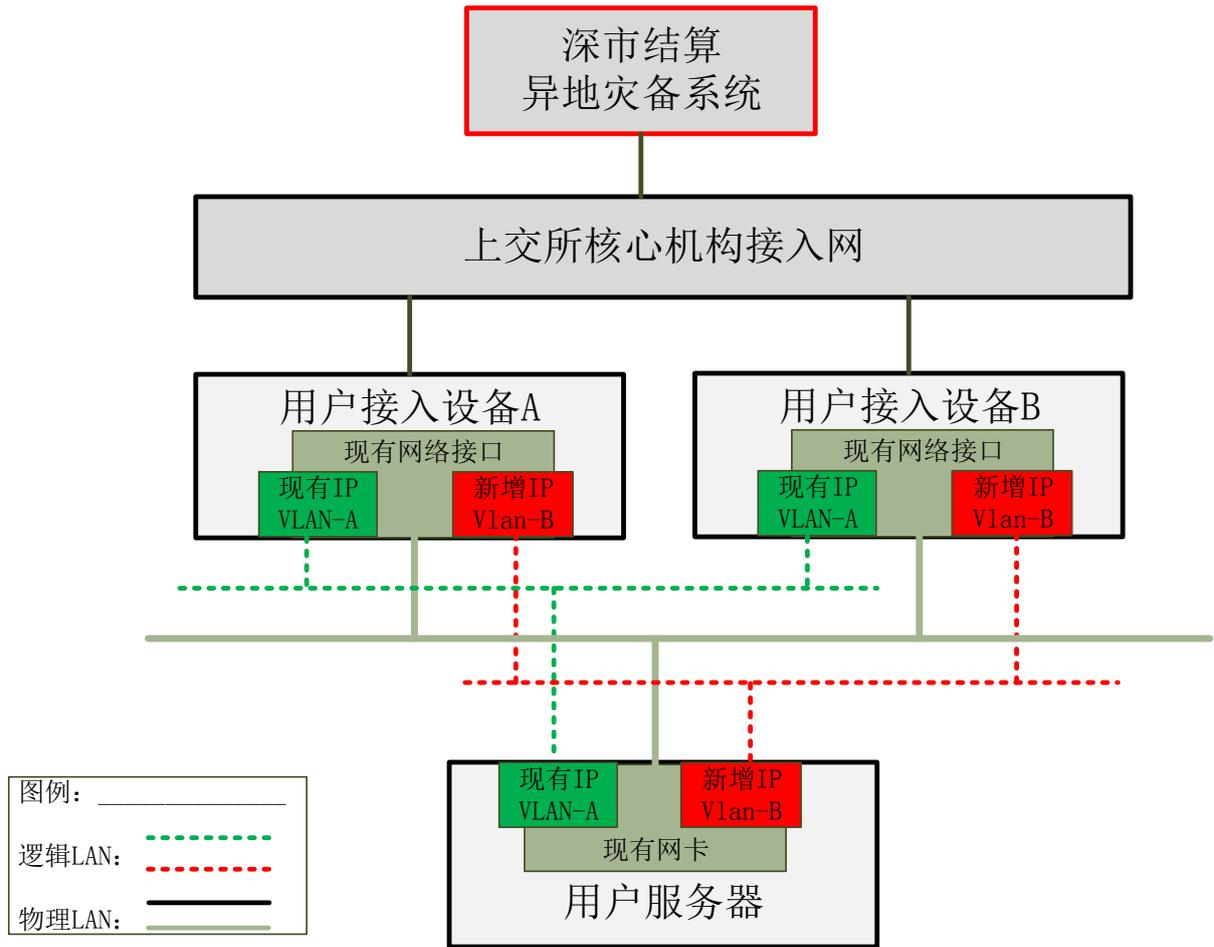
图5 托管用户接入模式——用户内网复用所有线路
