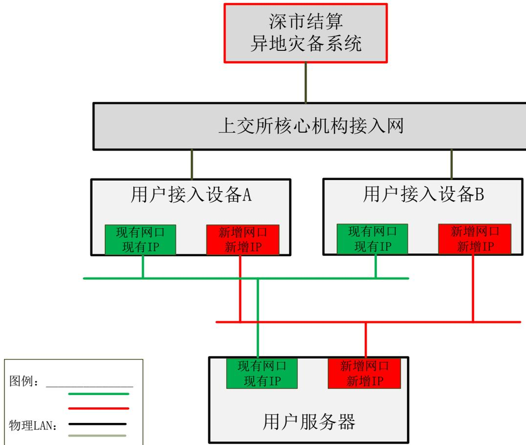
图 6 托管用户接入模式——用户内网新增线路
